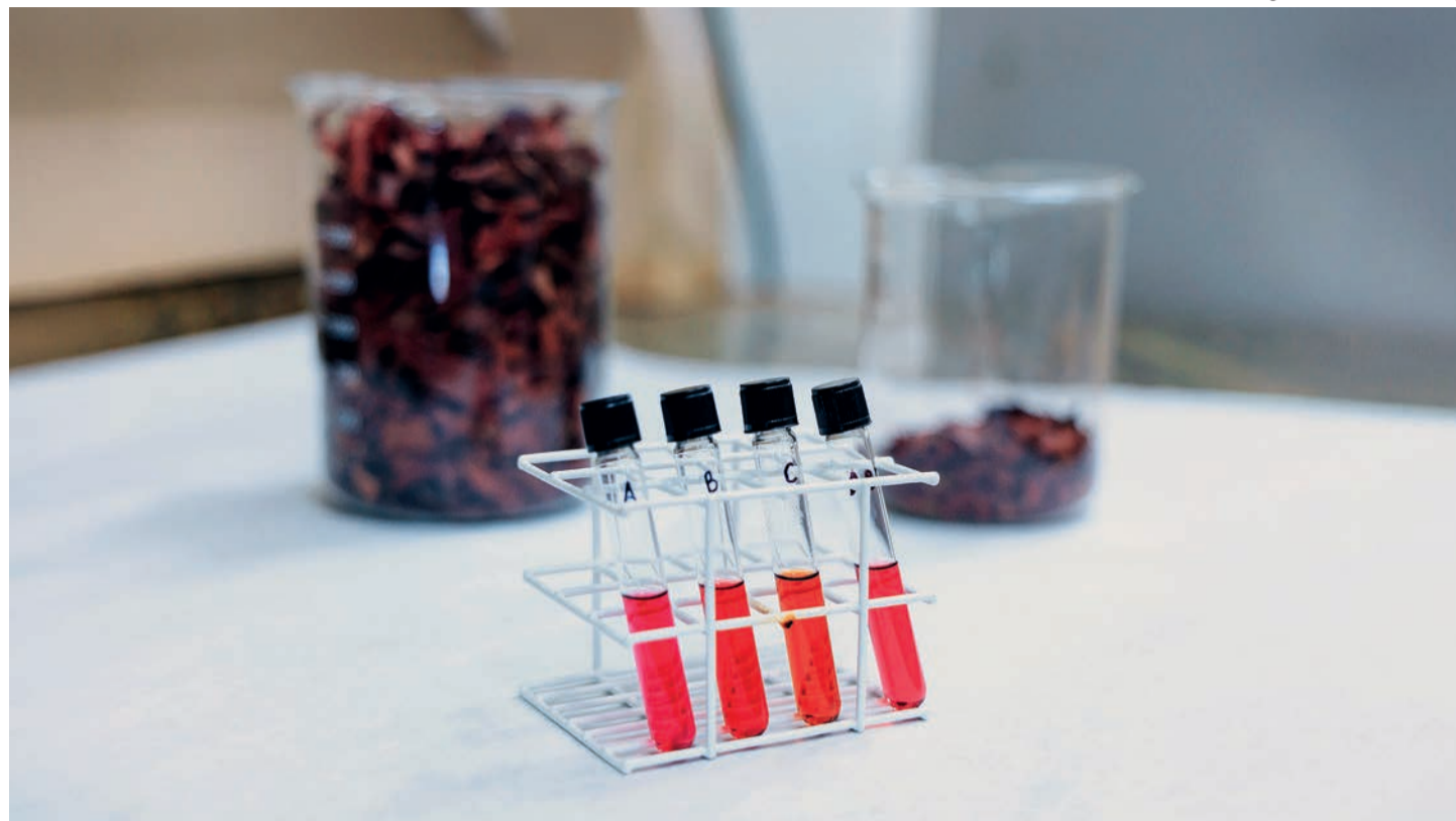
Corante desenvolvido no CPQBA a partir da combinação de extratos naturais alcança diferentes tons de vermelho e garante mais estabilidade
