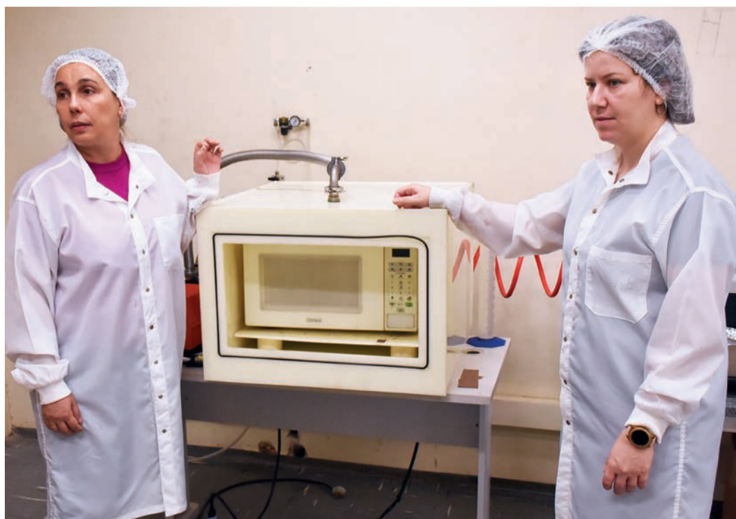
As químicas Silvia Vaz Guerra Nista (à esquerda) e Larissa Giorgetti Mendes: transformando a lignina em estruturas grafíticas porosas em apenas 30 segundos
