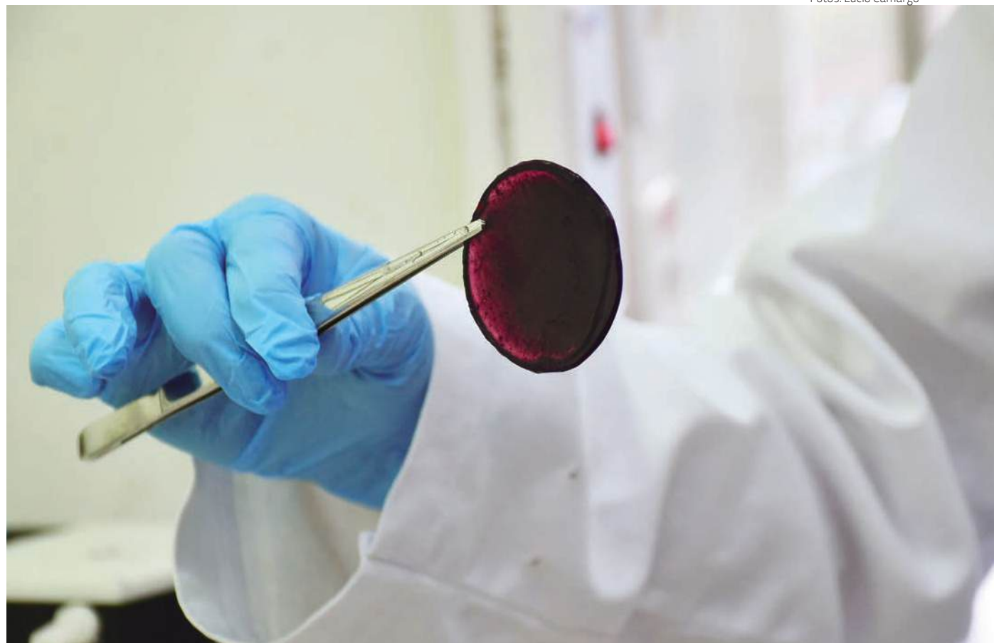
Manipulação de membrana em laboratório da FT: feito com polímero sintético, material é enriquecido com derivado de óxido de grafeno
