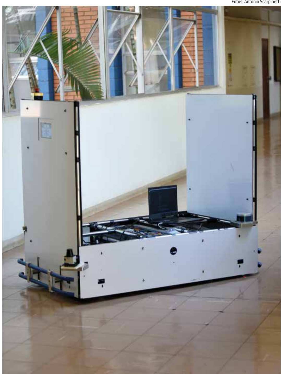
O robô na Faculdade de Engenharia Mecânica: sistema otimiza transporte de mercadorias dentro da fábrica
