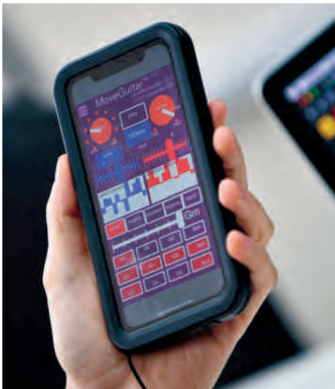
Aplicativo MoveGuitar: recurso usa acelerômetro interno de smartphones para capturar movimentos
