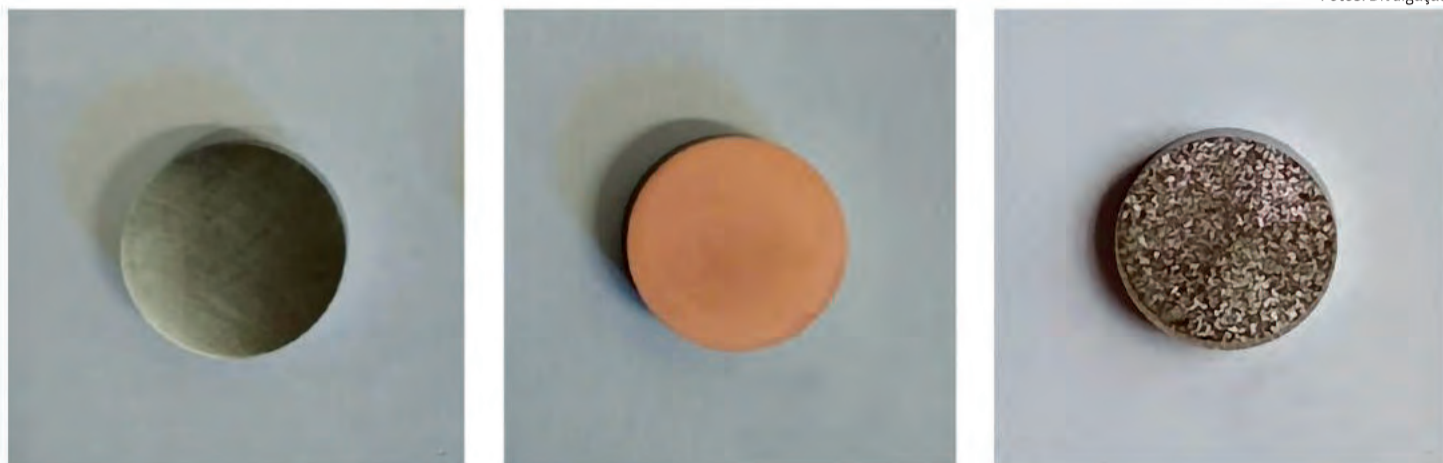
Na sequência, a peça de titânio (à esq.), filme de cobre sobre a peça (centro) e, por fim, o revestimento depois de o material passar por tratamento térmico
