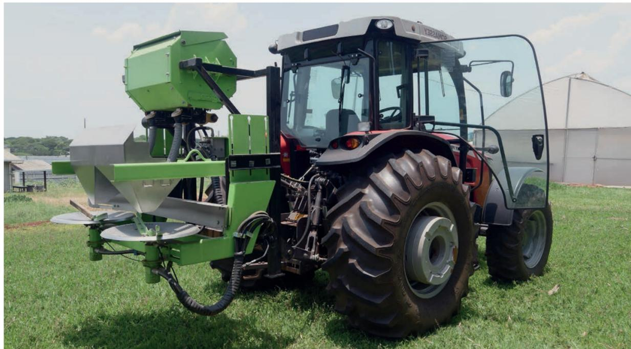
Distribuidor de fertilizantes e corretivos para o solo acoplado em trator recentemente adquirido pela Feagri: controles de velocidade independentes
